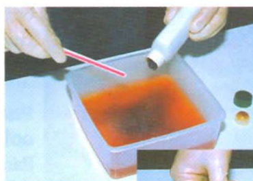
Figura 9.34 El circuito con las pistas dibujadas se sumerge en el ácido para rebajar el cobre sobrante
