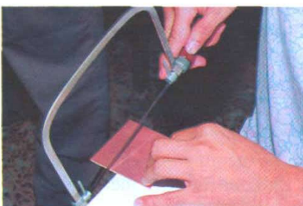
Figura 9.27 La plaqueta de cobre se debe cortar al tamaño indicado por el diseño final
