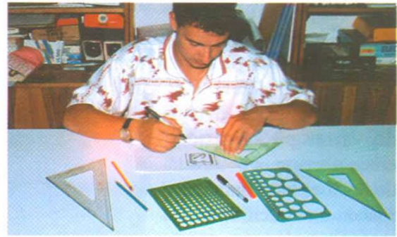
Figura 9.25 El diseño definitivo del circuito impreso se puede hacer con reglas y plantillas especiales.
