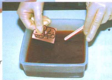
Figura 9.34 El circuito con las pistas dibujadas se sumerge en el ácido para rebajar el cobre sobrante
