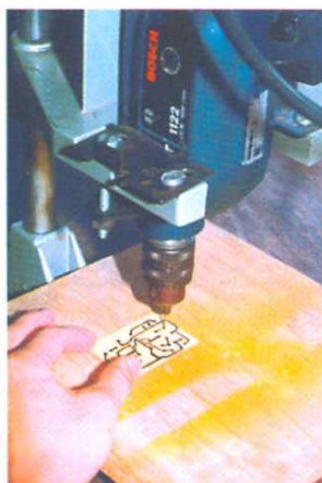
Figura 9.35 Las perforaciones para insertar los componentes se pueden hacer con un taladro o un Moto-tool.
