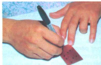
Figura 9.32 En los sitios donde se marcaron las perforaciones con la aguja, se deben dibujar los círculos o donas del circuito impreso
